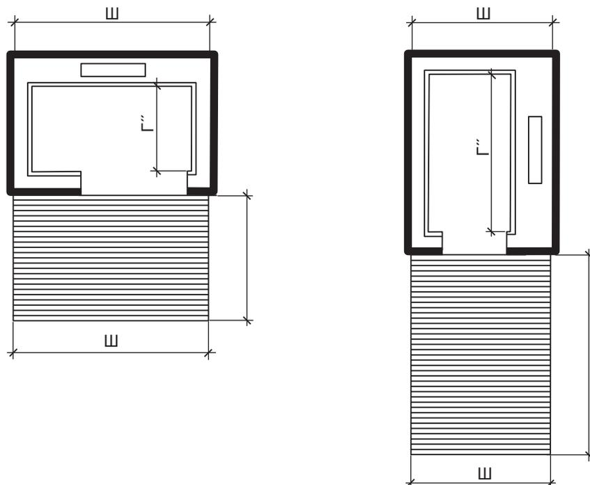
Ш×Г — разгрузочная зона; Ш — размер, равный внутреннему размеру ширины шахты;
